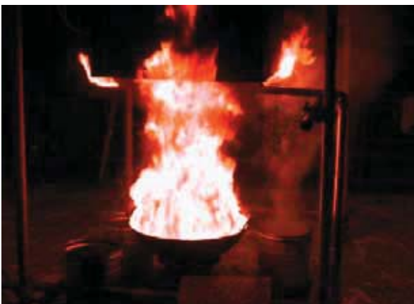
③フード・ダクト内の各温度測定点における温度経過、及び、油の温度経過のデータをとる
